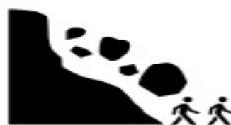
Ras: jordmassor har lossnat och faller fritt i luften.
