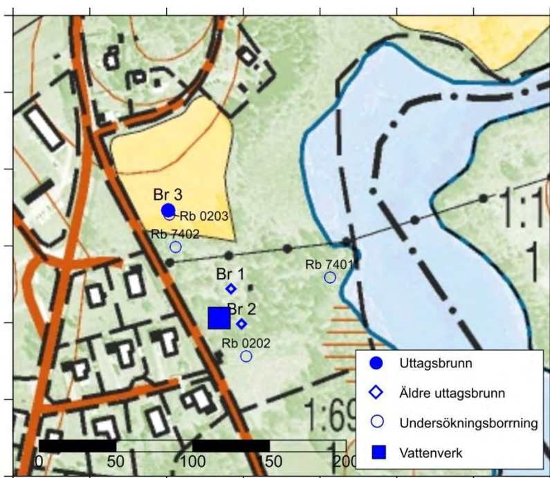
Figur 2. Nuvarande uttagsbrunn (Br 3), tidigare råvattenbrunn (Br 2) och renvattenbrunn (Br 1) samt tidigare undersökningsborrningar. Br 3 hette tidigare Rb 0201.
