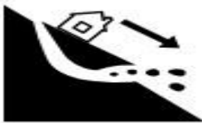
Skred: jordmassor har lossnat och glidit iväg längs marken.
