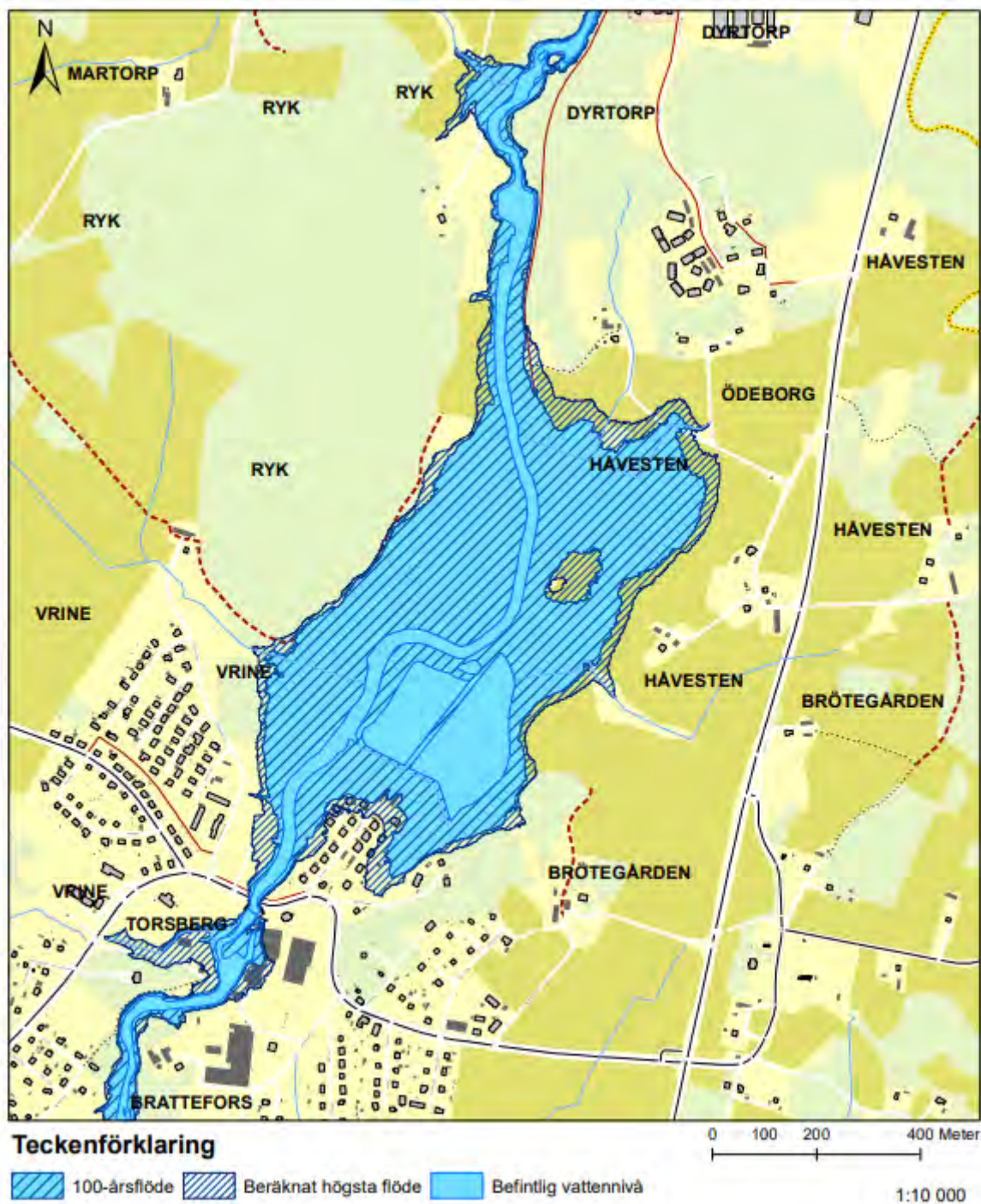
Bilden ovan visar översvämningskartering i Ödeborg och det beräknade flödet av Örekilsälvens och Munkedalsälvens avrinningsområde (MSB, u.å).
